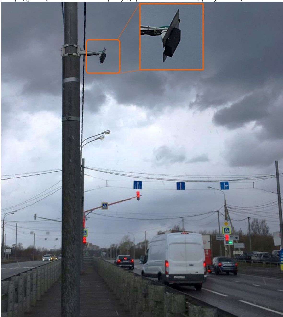
Рисунок 15. Фотография установки радара «Поток-1» на объекте эксплуатации.
