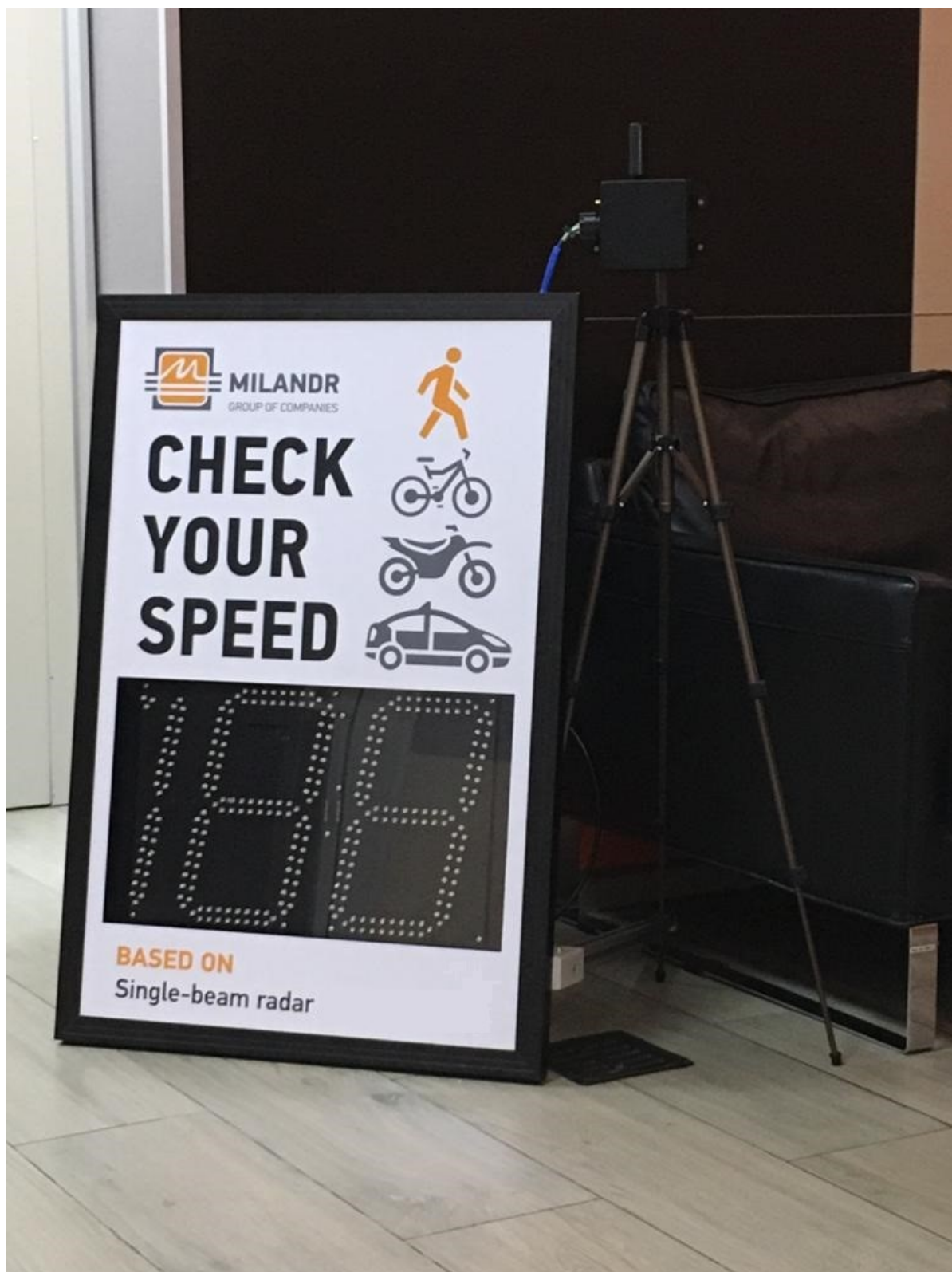
Рисунок 16. Применение радара скорость для информирования о опасном участке дороги.
